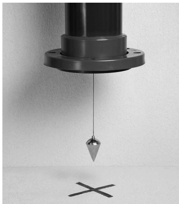
Фиг. 2 Маркиране на центъра на входната тръба
