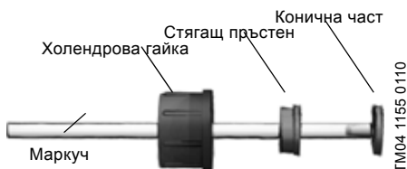
Фиг. 8 Хидравлично свързване
