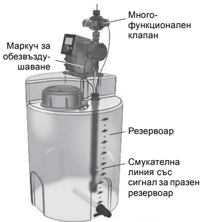
Фиг. 9 Пример за монтаж
