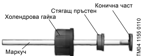
Фиг. 6 Хидравлично свързване
