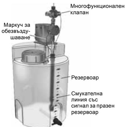
Фиг. 7 Пример за монтаж
