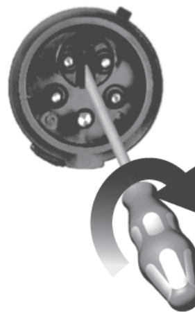
Фиг. 8 Размяна на фазите на трифазен контролер с инвертор на фазите
