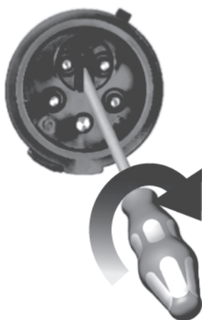
Фиг. 17 Размяна на фазите на трифазен контролер с инвертор на фазите
