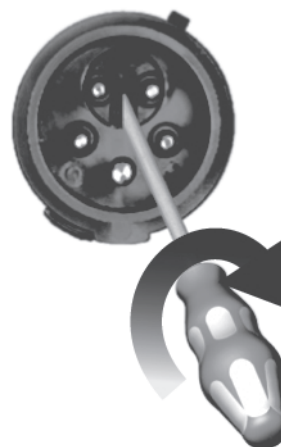
Фиг. 13 Размяна на фазите на трифазен контролер с инвертор на фазите (< 5 kW)
