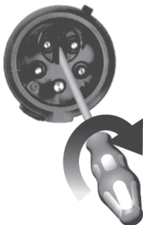
Фиг. 14 Размяна на фазите на трифазен контролер с инвертор на фазите
