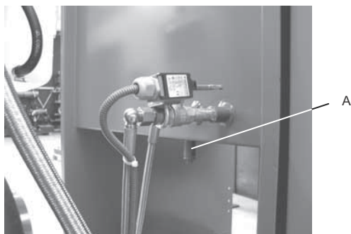
Фиг. 50 Пробка за източване на резервоара за гориво
